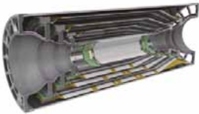
シリコンバーテックス検出器の 3D 図面
